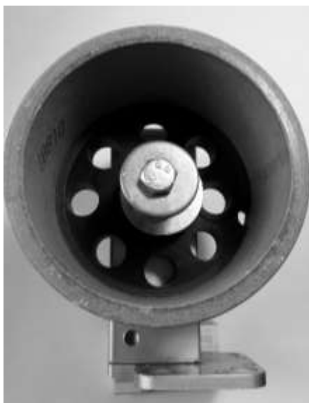
Рис. 2. Катушка и патрон с нитью. Масса 0,075 кг
