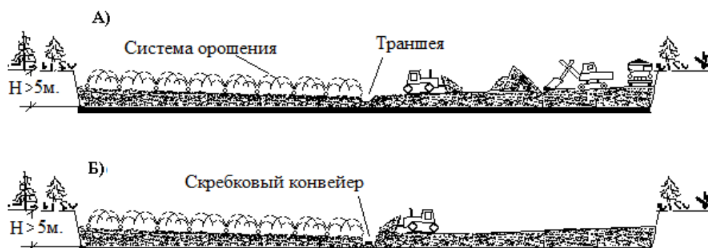
Рис. 1. Технология работ с при искусственной оттайке дождеванием
